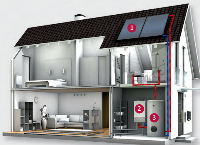
mit solarer Warmwasserbereitung
